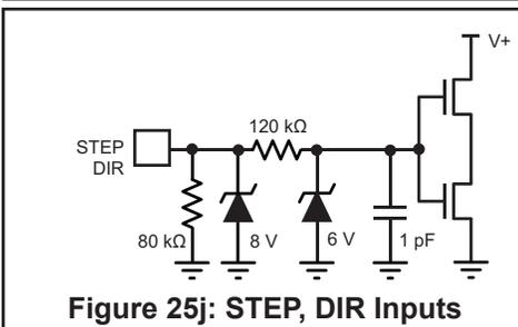
Figure 25j: STEP, DIR Inputs
